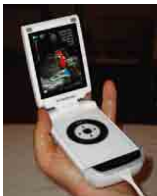
図1 手の上のVscan 左手の上にスッポリ収まる。パネル面もスッキリ。往診カバン内というより、ポケット内に入れて持ち運ぶことができる。
