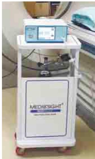
図5 国立がんセンターとメディックサイト社で共同開発中のCTC用CO<sub>2</sub>自動注入器
